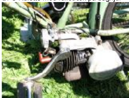
Motoren trækkes ind mod baghjulet med den sorte trækstang
