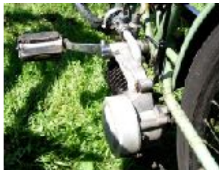
Motoren trækkes ind mod baghjulet med den sorte trækstang
